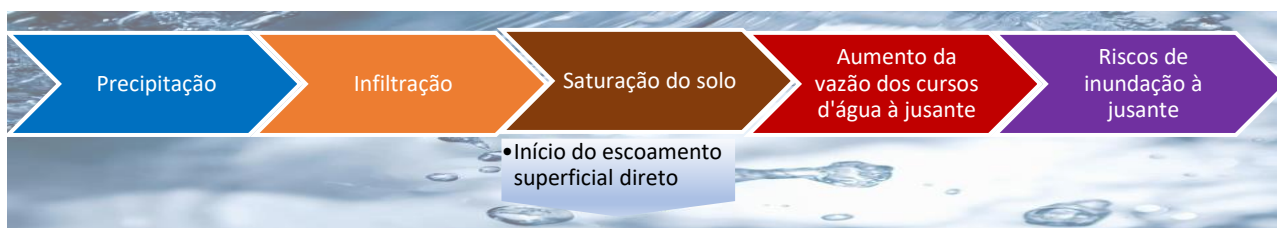
Figura 31: caminho clássico simplificado seguido pela água entre a precipitação e a formação de uma inundação à jusante
