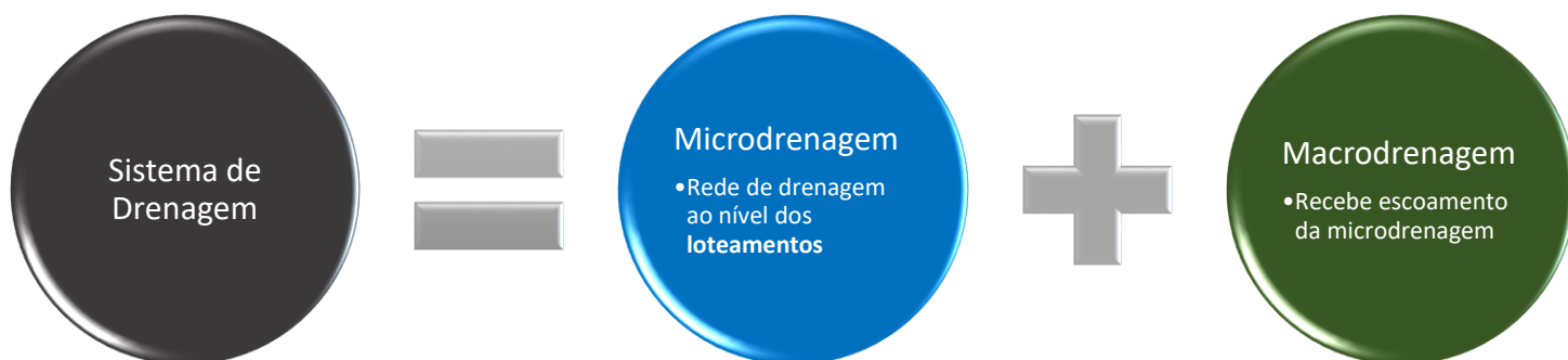
Figura 51: partes de um sistema de drenagem
