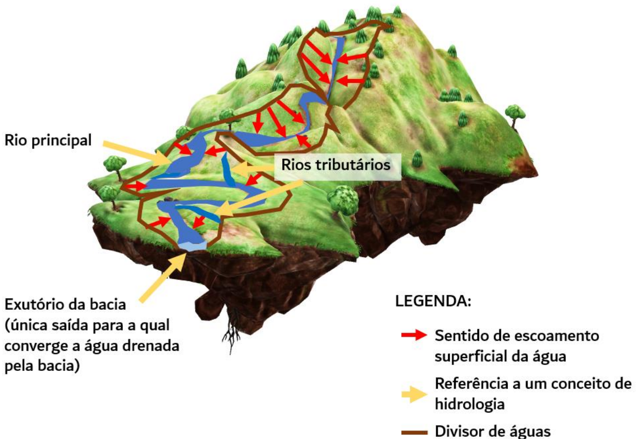
Figura 9: bacia hidrográfica delimitada pelos divisores em marrom e com setas em vermelho mostrando sentido de escoamento das águas
