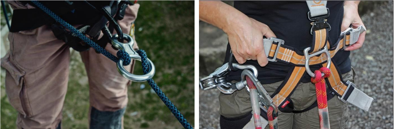
Figura 8: Exemplos de ligações de cinto de segurança com o talabarte
