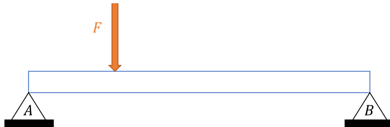
Viga biapoiada com carga concentrada
