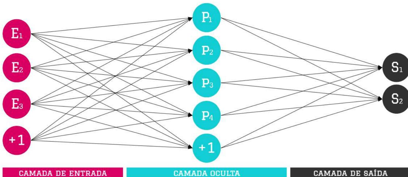
Já em contraste com a arquitetura anterior, aqui são utilizados perceptrons modernos, isto é, aqueles cuja função de ativação é uma função sigmóide. Aos dados de entrada são aplicados pesos, em seguida eles são sendo processados pela camada oculta até chegarem a um resultado de saída. Um exemplo resultado de saída poderia ser a probabilidade de uma pessoa ser do gênero masculino ou feminino, de forma que aquela que tivesse maior probabilidade seria a previsão do algoritmo.
