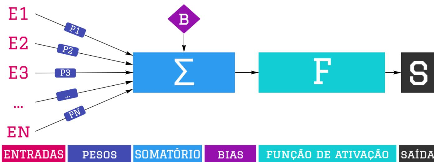
Note que temos um conjunto de  $n$  entradas ( $e_1, e_2, e_3, \dots, e_n$ ) que são multiplicadas por pesos específicos associados a cada entrada ( $p_1, p_2, p_3, \dots, p_n$ ). Cada um desses pesos é livremente ajustável de forma independente dos demais. Em seguida, nós realizamos a soma de cada entrada multiplicada por seu respectivo peso associado. E o próximo passo é somar tudo isso com uma entrada especial denominada viés ou *bias* ( $b$ ).
