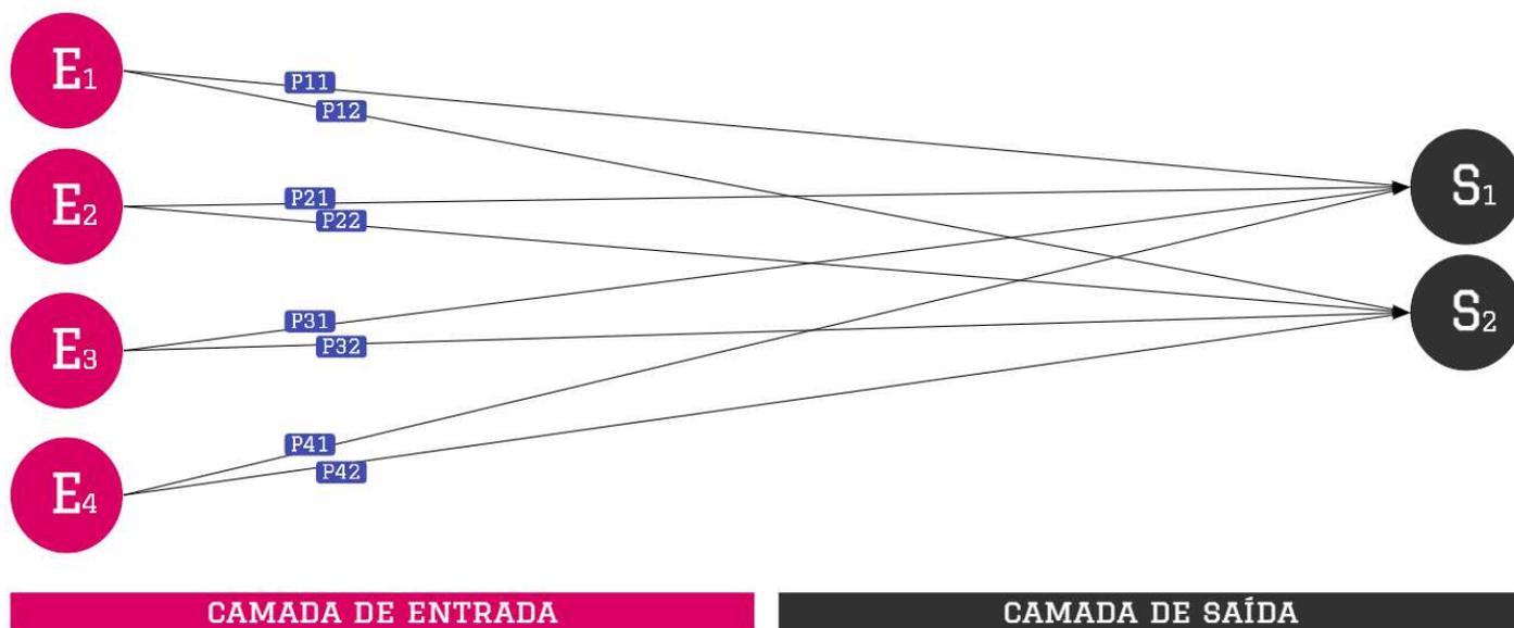
Esse tipo de rede neural é raramente utilizado justamente por utilizar perceptrons originais, isto é, aqueles cuja função de ativação é uma função de limite (em formato de degrau). Esse tipo de redes neurais é mais adequado para resolver problemas de classificação, porém apenas aqueles em que as classes são linearmente separáveis. *Como é, Diego?* Isso significa que ele só lida com situações em que é possível traçar ao menos uma linha reta separando classes em um plano coordenado<sup>5</sup>.
