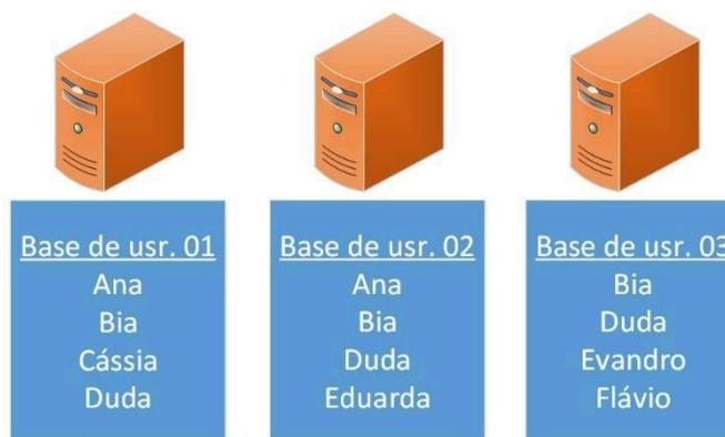
E o que é um **diretório**? É uma base de dados "única". Os servidores possuem uma cópia da base (por isso coloquei única entre aspas), sendo que as alterações são replicadas entre os servidores. Isso permite redes de grandes proporções.
