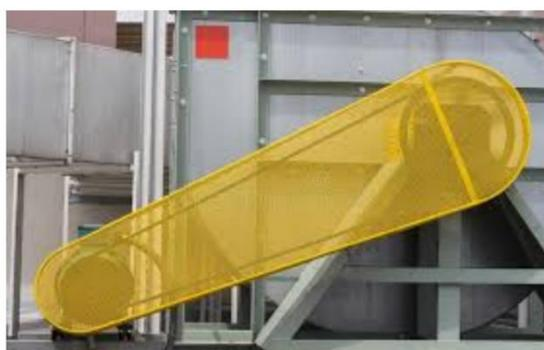
**Figura 1.2:** Sistema de transmissão de potência com proteção<sup>2</sup>
