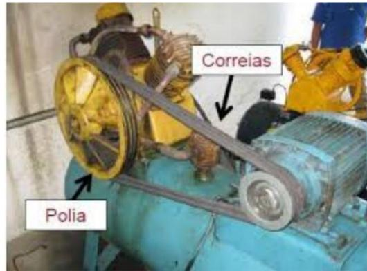
**Figura 1.1:** Sistema de transmissão de potência sem proteção<sup>1</sup>
