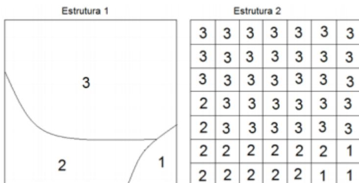
Figura 1: Mapa de uso do solo utilizando duas diferentes estruturas em SIG.
