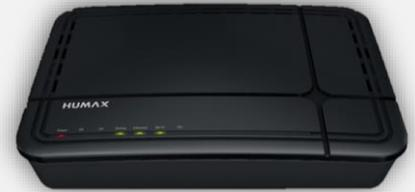
Equipamento capaz de converter sinais digitais em sinais analógicos e vice-versa, em geral por meio de uma linha telefônica. Os três modelos principais são: Acesso Discado; Modem ADSL; e Cable Modem.
