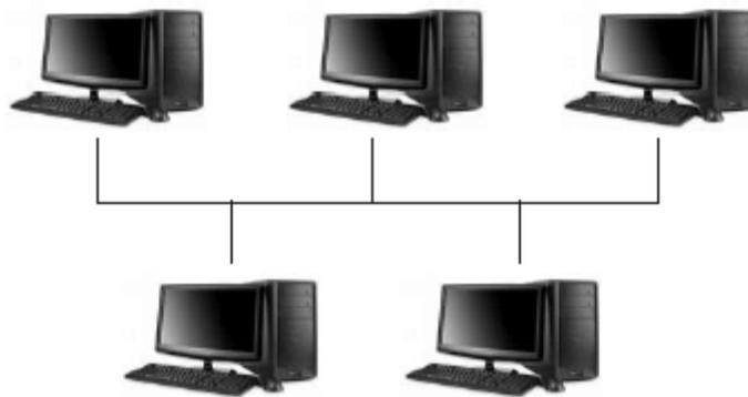
**10. (CESGRANRIO / TRANSPETRO - 2011) A figura acima mostra uma topologia típica de uma rede industrial de comunicação onde todos os dispositivos compartilham o mesmo meio físico de comunicação. O controle pode ser centralizado ou distribuído. Além de possuir alto poder de expansão, nós com falha não prejudicam necessariamente os demais. Qual a topologia descrita?**
