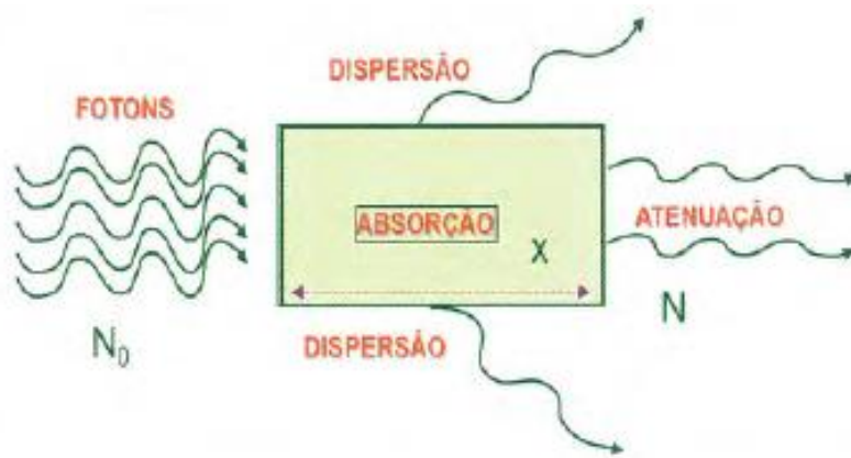
Formas de atenuação do feixe. Imagem retirada de Neto, Kurita e Campos (2019).
