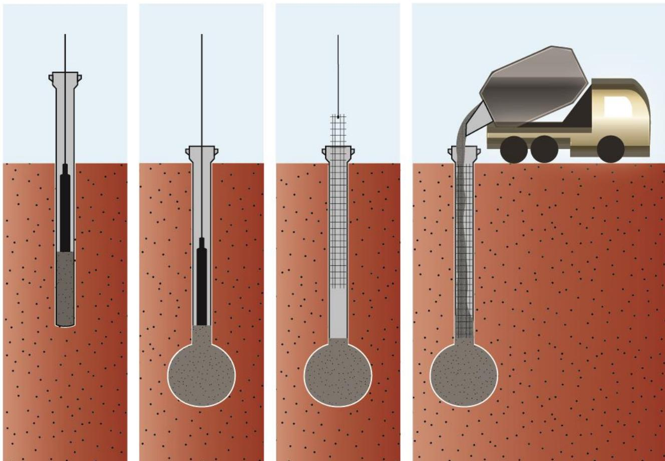
Figura 51: Estaca Franki, observe a ponta alargada
