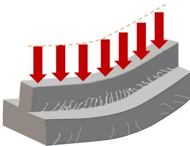
Figura 16: sapata corrida sofrendo flexão, com alta sujeição a trincas na porção tracionada<sup>11</sup>
