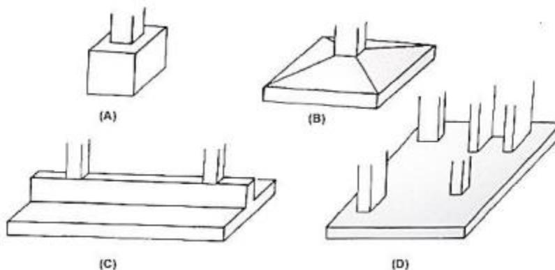
1 - viga de fundação - elemento de fundação que recebe pilares alinhados, geralmente de concreto armado; pode ter seção transversal, tipo bloco (sem armadura transversal).
