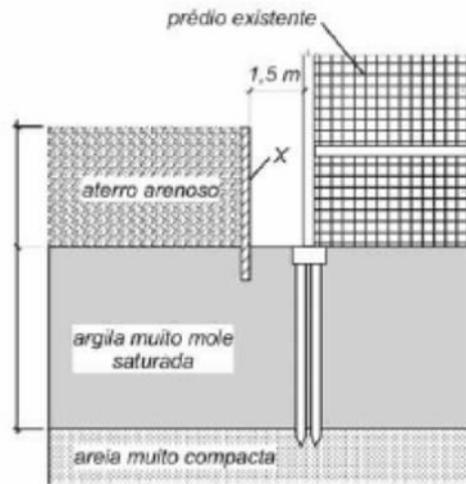
Considerando as condições apresentadas na figura acima, que ilustra um aterro arenoso a ser construído sobre uma camada de argila muito mole saturada, próxima a um prédio existente, julgue o item a seguir.
