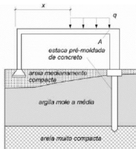
A figura acima ilustra as fundações de um pórtico plano de concreto armado que será submetido a um carregamento não nulo  $q$ , uniformemente distribuído, não previsto inicialmente.
