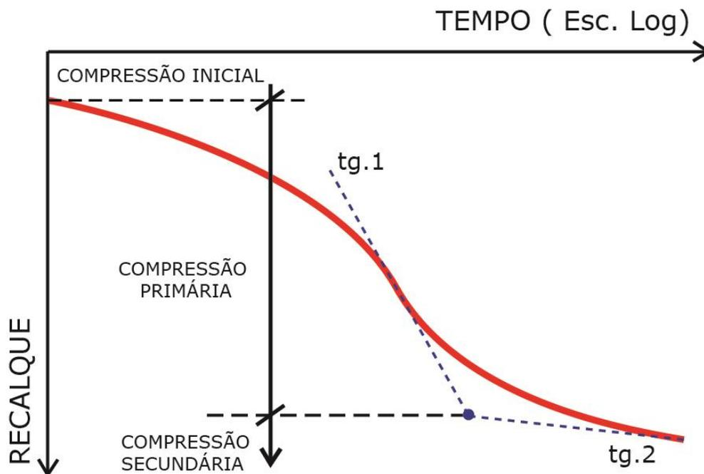
Figura 38: Curva típica de Tempo-recalque em um adensamento
