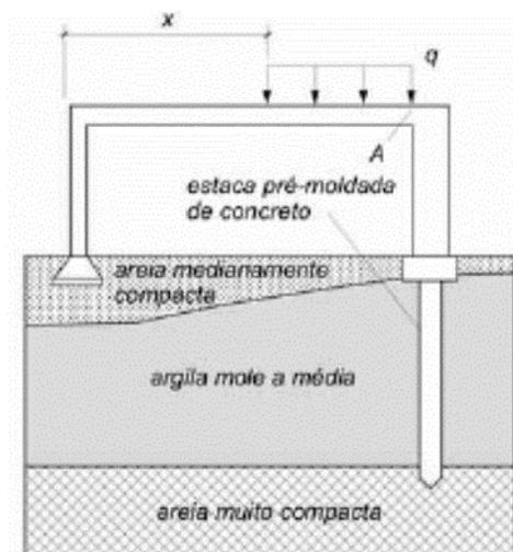
A figura acima ilustra as fundações de um pórtico plano de concreto armado que será submetido a um carregamento não nulo  $q$ , uniformemente distribuído, não previsto inicialmente.
