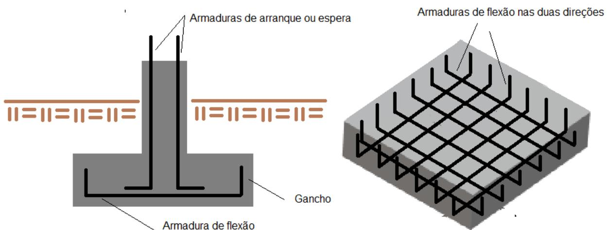
Figura 21: Armaduras de flexão e arranque em sapatas.
