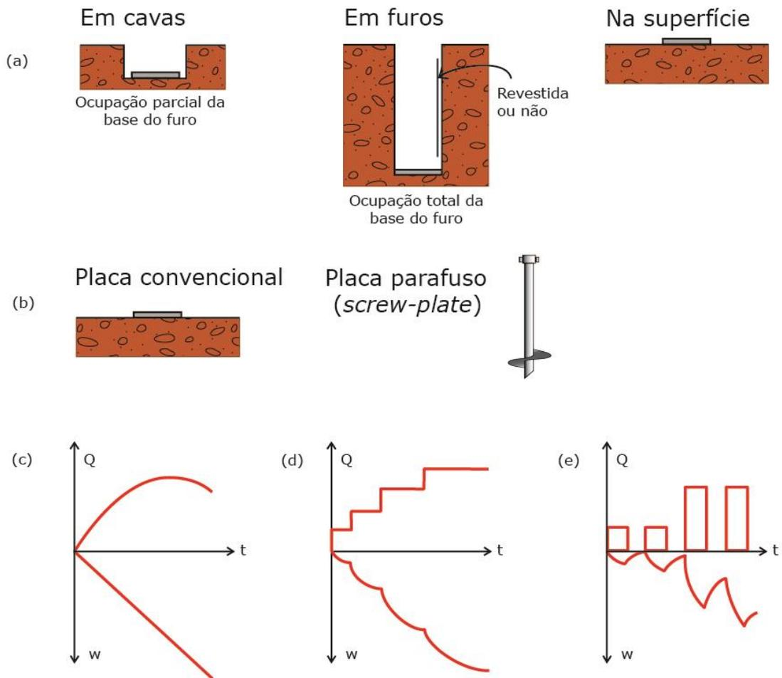
Figura 30: Os vários tipos de ensaios de placa
