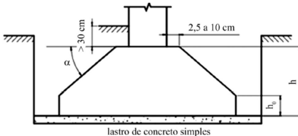
A fim de evitar o uso de fôrma na construção da sapata da estrutura ilustrada na figura 24A2, o ângulo  $\alpha$  deve ser, preferencialmente, igual ou inferior a
