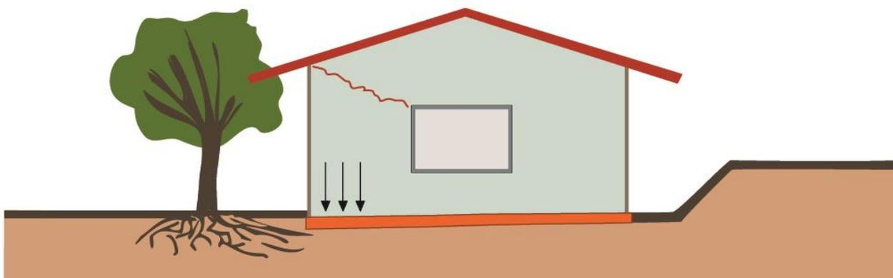
Figura 45: Recalque por solapamento de base de fundação
