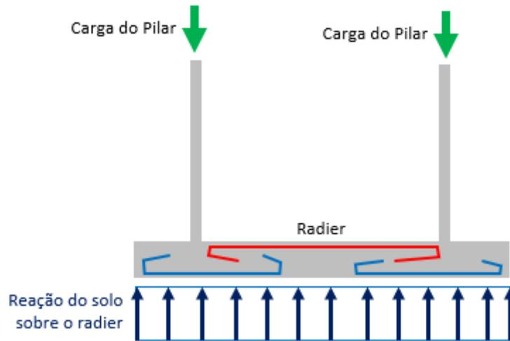
Figura 18: disposição da armadura em um radier
