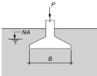
Sabendo que a figura acima apresenta um elemento de fundação com área em planta retangular com largura  $B$  e comprimento (normal ao plano do desenho) igual a  $L$ , julgue o item a seguir.
