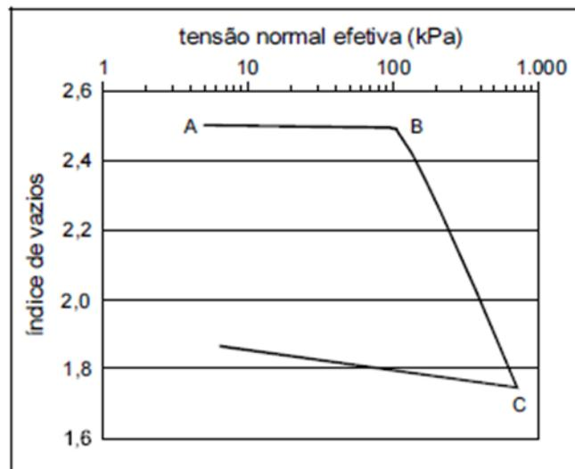
Considerando a figura acima, que apresenta a curva de adensamento de uma argila, obtida a partir de ensaio de adensamento unidimensional convencional, julgue os itens que se seguem.
