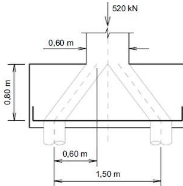
Para o dimensionamento desse bloco, a força de compressão nas bielas é igual a
