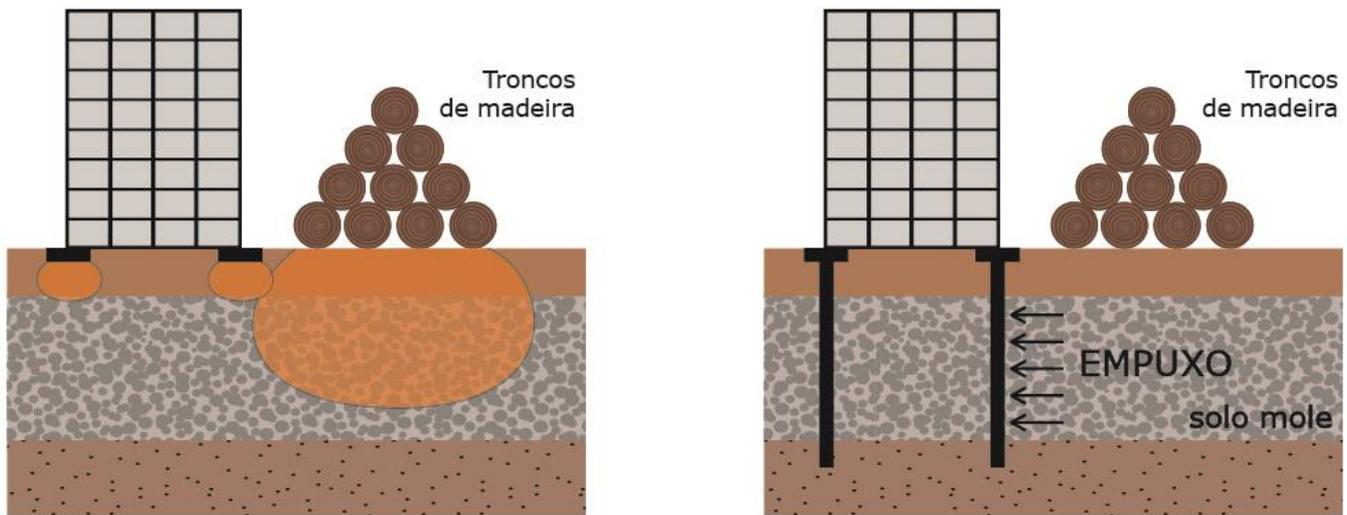
Figura 56: Efeitos de sobrecarga sobre diferentes fundações
