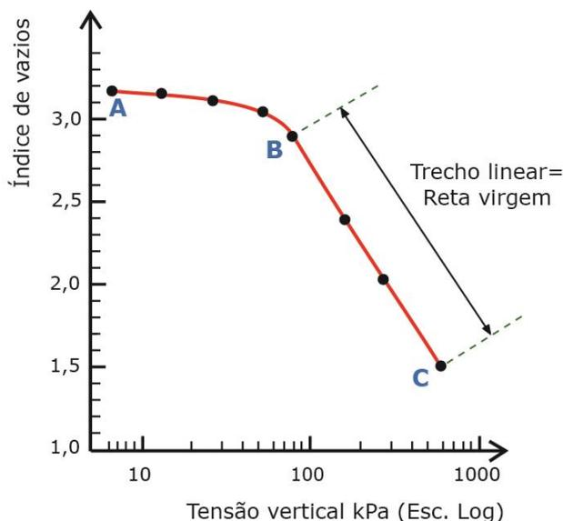
Figura 33: Gráfico obtido no ensaio de adensamento
