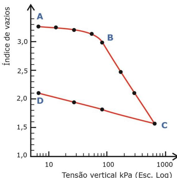
Figura 36: Redução da carga de compressão após adensamento
