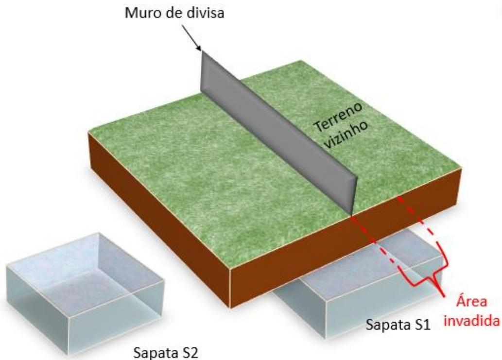
Figura 7: Localização de uma sapata de divisa invadindo terreno vizinho (os pilares não foram desenhados para não poluir a imagem)
