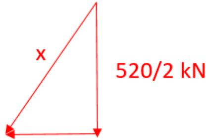
Para saber o valor de x, podemos fazer uma comparação de triângulos equivalentes, conforme a seguir:
