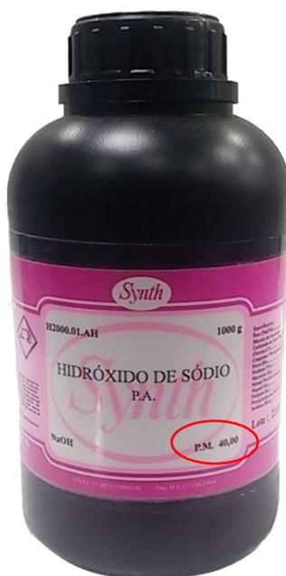
Figura 3: a embalagem de NaOH da marca Synth. Em destaque indicação do peso molecular que devemos utilizar para calcular massa para preparo de solução.
