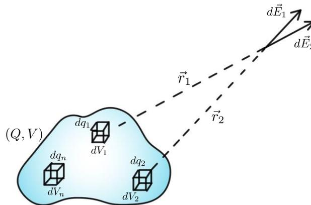
Figura 6-Campo elétrico de uma distribuição contínua de cargas.
