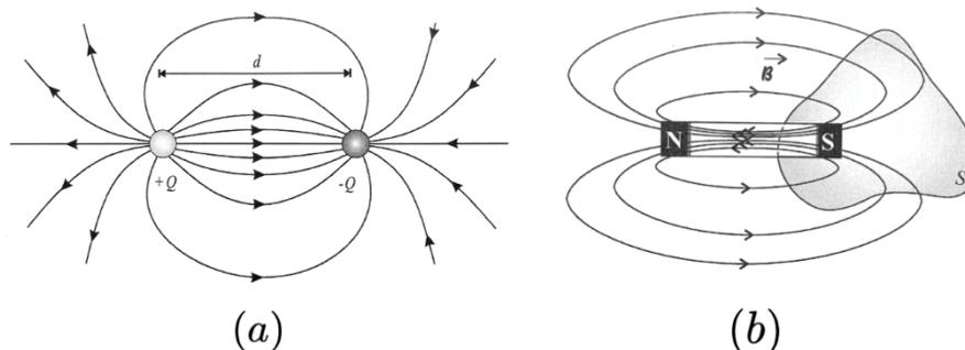
Perceba que o campo elétrico (dipolo) “nasce” na carga  $+Q$  e “morre” na carga  $-Q$ , dessa forma, temos **linhas de campo aberto** para o campo elétrico.
