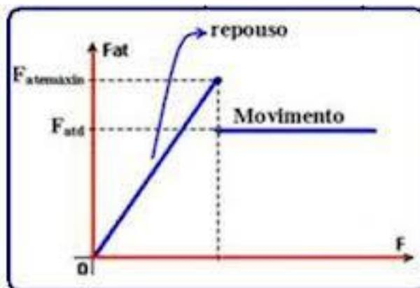
O freio ABS não permite a parte do gráfico em que o atrito é constante, ele sempre faz com que o atrito seja crescente, facilitando assim o processo de frenagem. Um gráfico apropriado para a frenagem em um carro equipado com freio ABS seria:
