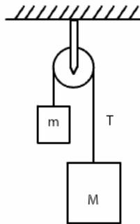
O esquema acima representa dois corpos de massa  $m$  e  $M$  ligados por um fio ideal que passa por uma polia de massa desprezível. Essa configuração de massas e polias é denominada máquina de Atwood. Considere que  $M = 2m$ , que o fio está submetido a uma tensão  $T$  e que a aceleração da gravidade,  $g$ , é igual a  $10,0 \text{ m/s}^2$ . Nessas condições, o módulo da aceleração dos corpos, em  $\text{m/s}^2$ , será aproximadamente igual a
