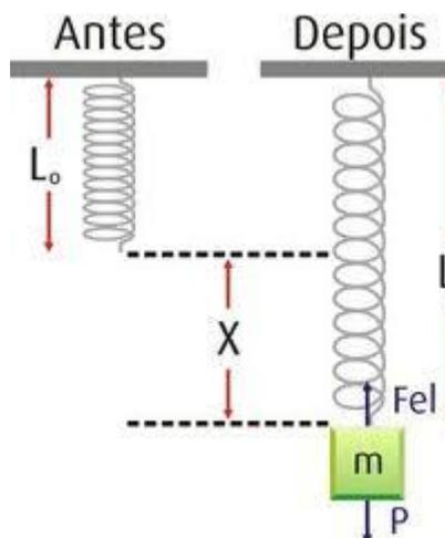
O peso do bloco acima deformou a mola de um valor  $x$ , e essa deformação gerou uma força elástica na mola que equilibrou o bloco na sua posição de equilíbrio estático (repouso).
