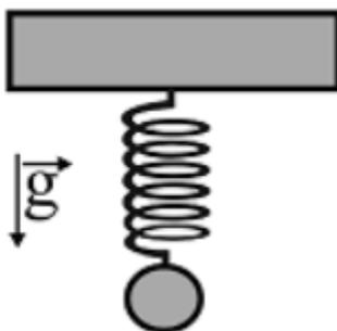
O sistema ilustrado na figura precedente mostra uma mola de constante elástica igual  $1 \text{ N/cm}$ , a qual sustenta uma massa de  $100 \text{ g}$ . Assumindo a aceleração da gravidade igual a  $9,8 \text{ m/s}^2$ , e  $3,14$  como o valor aproximado de  $\pi$ , julgue o item seguinte.
