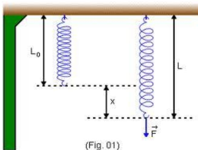
Veja que a mola ideal possuía um comprimento natural  $L_0$  e após a aplicação de uma força  $F$ , ela passou a ter um comprimento diferente,  $L$ .
