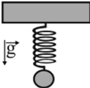
O sistema ilustrado na figura precedente mostra uma mola de constante elástica igual  $1 \text{ N/cm}$ , a qual sustenta uma massa de  $100 \text{ g}$ . Assumindo a aceleração da gravidade igual a  $9,8 \text{ m/s}^2$ , e  $3,14$  como o valor aproximado de  $\pi$ , julgue o item seguinte.
