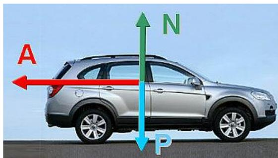
Na figura acima foram representadas três forças no veículo: a força peso ( $P$ ), a força de resistência do ar ( $A$ ) e a **força normal ( $N$ )**.
