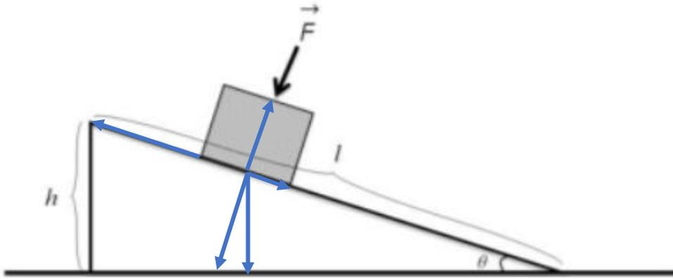
Perceba a decomposição da força peso na figura, assim como a força de atrito contrária ao movimento de descida do bloco e a Força Normal que devemos calcular para usarmos o coeficiente de atrito. Façamos as condições de equilíbrio:
