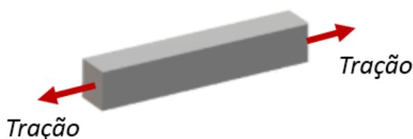
Figura 43: tração simples em uma viga
