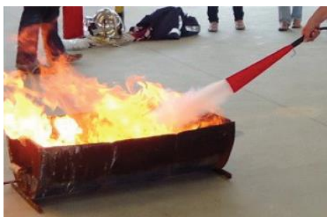
Figura 1.9: Extinção química com extintor halon ou CFC.
