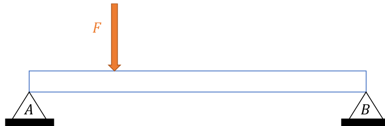
Viga biapoiada com carga concentrada
