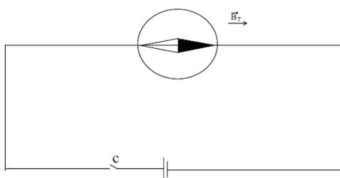
Num determinado momento, a chave é ligada e uma corrente contínua passa a percorrer esse condutor no mesmo sentido do campo magnético terrestre. Sabendo que o módulo do campo magnético gerado por essa corrente onde está colocada a bússola é igual ao módulo do campo magnético terrestre no local, assinale a alternativa que melhor representa a agulha da bússola depois da chave ligada.
