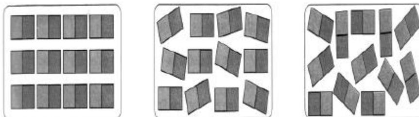
O campo magnético do ímã alinha **os spins do metal ferromagnético orientando-os e assim tornando o metal com propriedades de um ímã**, é esse tipo de ímã, que passa por esse processo, que chamamos **de ímã artificial**.
