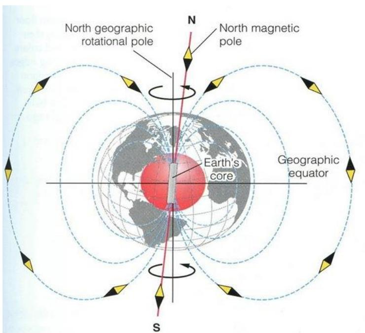
Observe na figura que o norte magnético da terra tem uma pequena diferença angular para o sul geográfico, essa diferença angular PE de aproximadamente  $11^\circ$ .
