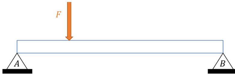
Viga biapoiada com carga concentrada
