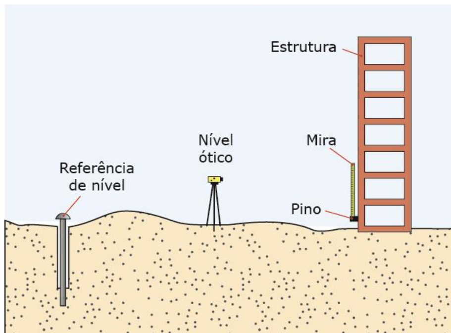
Figura 46: Nível ótico com mira para medição da estrutura
