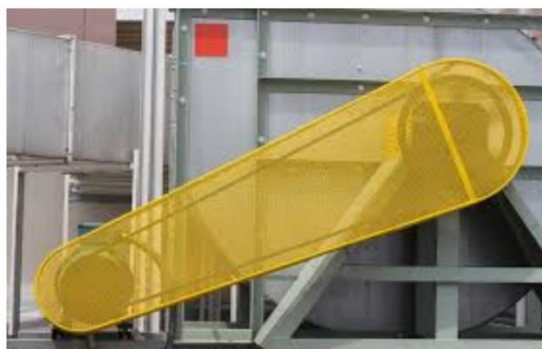
Figura 1.2: Sistema de transmissão de potência com proteção 2
