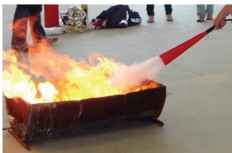
Figura 1.9: Extinção química com extintor halon ou CFC.
