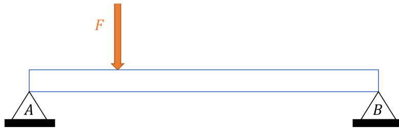
Viga biapoiada com carga concentrada
