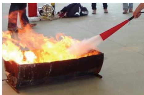
Figura 1.9: Extinção química com extintor halon ou CFC.
