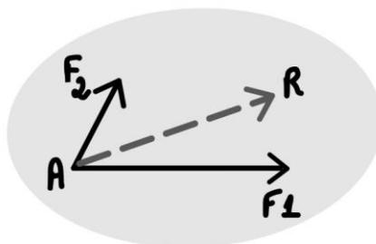
Quando abordamos a decomposição bidimensional de um vetor de força, aplicamos a **regra do paralelogramo**, onde o **vetor F** pode ser escrito como a **soma entre** as respectivas **componentes X e Y**. Os componentes escalares podem ser de grandeza positiva ou negativa de acordo para qual quadrante F aponta. A figura abaixo representa a regra do paralelogramo onde os valores de cada componente do vetor F podem ser calculados pelas seguintes equações:
