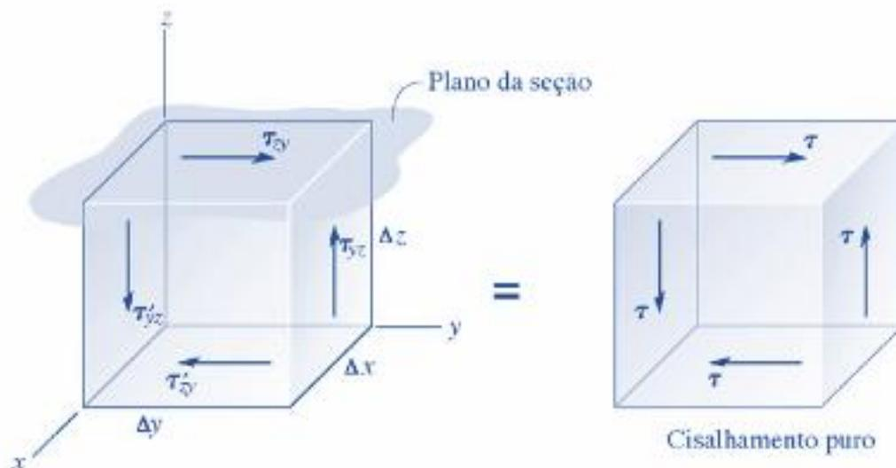
Analisando a imagem notamos que o equilíbrio de forças e momentos fazem com que a tensão de cisalhamento agindo sobre a face superior do elemento seja acompanhada pelas demais tensões que agem sobre as outras três faces.
