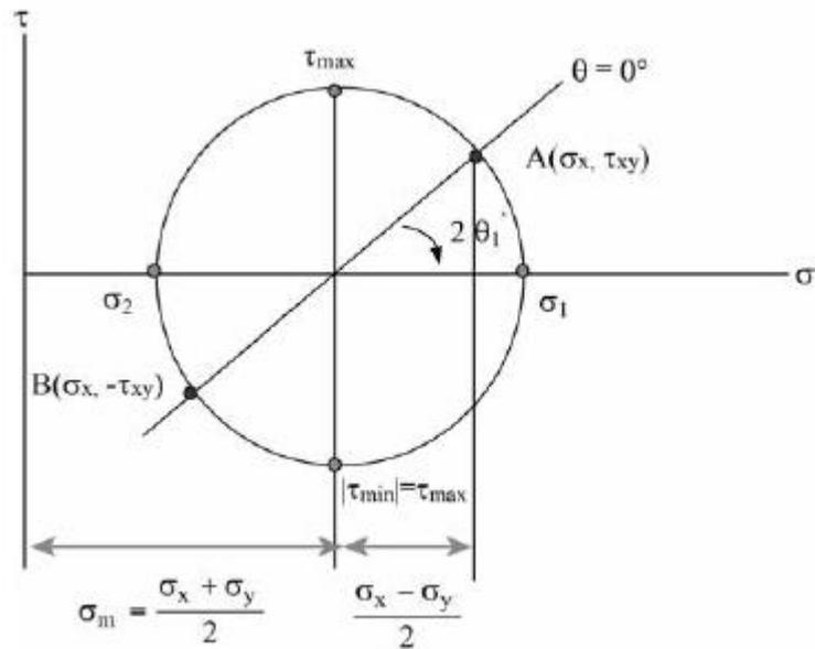
A figura precedente ilustra o círculo de tensões de Mohr, em que a ordenada de um ponto sobre o círculo representa a tensão de cisalhamento ( $\tau$ ) e a abcissa representa a tensão normal ( $\sigma$ ).
