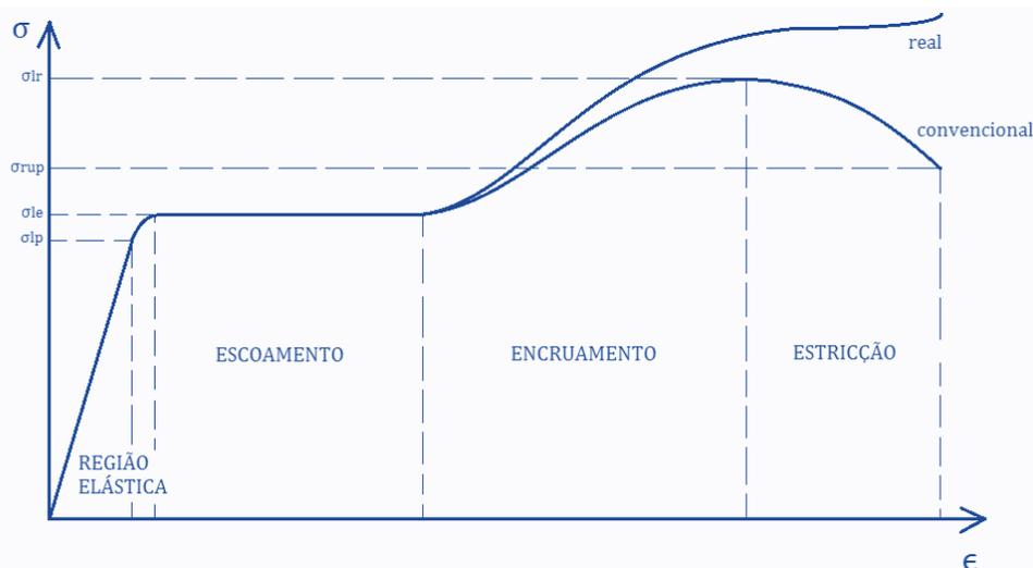
Quando se é calculado os valores de tensão e deformação a partir da área da seção transversal e o comprimento do corpo de prova no instante em que a carga é medida a obtemos a curva tensão X deformação real exemplificada na figura acima. Apesar de o diagrama de tensão-deformação convencional e real serem diferentes a maioria dos estudos e projetos são voltados dentro da região elástica do material.
