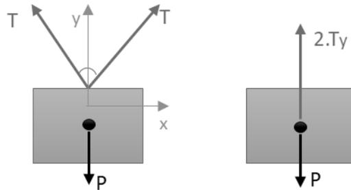
Como as barras possuem **mesma dimensão** AB e BC são idênticas e está apoiadas igualmente podemos simplificar o nosso diagrama de corpo livre conforme a figura a direita acima. Para finalizarmos aplicamos as equações de equilíbrio no eixo y, decompondo a força trativa de acordo com seu cosseno diretor, para obtermos a resposta. Vejamos:
