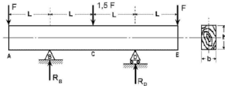
O carregamento mostrado na figura acima consiste em uma viga de madeira biapoiada, de área de seção  $h$  x  $b$  e comprimento  $4L$ . Com relação a essa viga, julgue o item seguinte.
