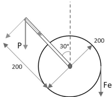
Neste caso o somatório dos momentos causados entre componente perpendicular a polia ( $P \cdot \sin 30^\circ$ ) e a força elástica (Fel) da mola deve ser igual a zero. Assim obtemos:
