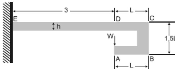
A figura acima mostra uma viga de seção retangular constante de altura  $h$  e momento de inércia  $I$ , submetida a um carregamento  $W$  aplicado no ponto  $A$ . Considerando essas informações julgue o item a seguir.
