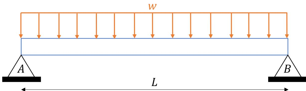
Caro(a) aluno(a). Vigas biapoiadas submetidas a um carregamento distribuído simetricamente ao longo de seu comprimento apresentam o momento fletor máximo no centro da viga. Isso ocorre justamente pela simetria da estrutura e dos carregamentos. Este tipo de apoio permite rotação da viga e devido ao fato de não serem momentos concentrados nas extremidades, os momentos fletores são nulos nos pontos A e B (extremidades).
