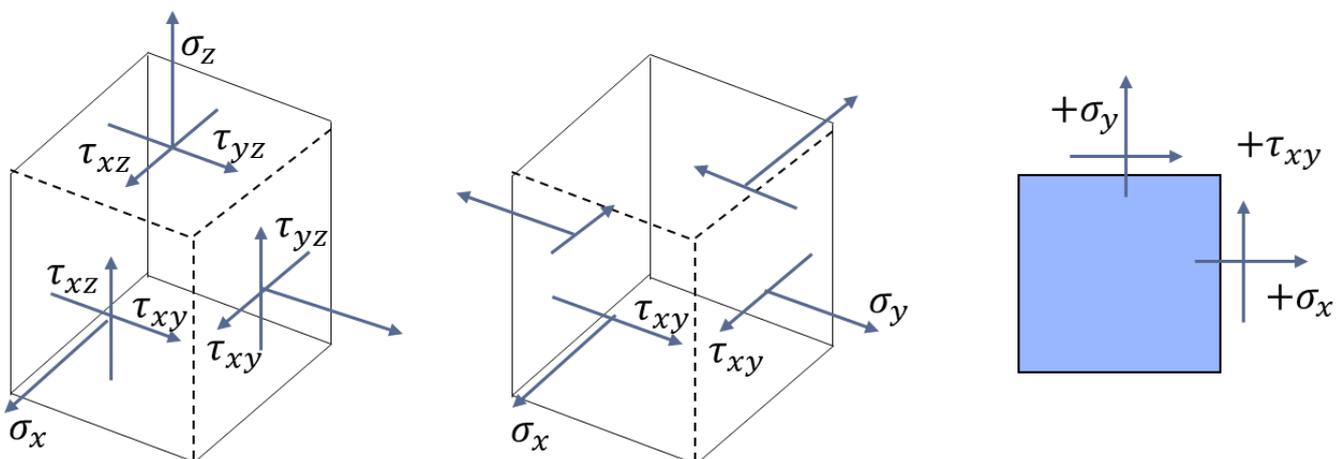
Visto isso, podemos afirmar que **se um estado de tensão em um ponto for conhecido**, de acordo com uma orientação determinada de um elemento do material, **podemos então determinar o estado de tensão para uma orientação diferente** através das seguintes equações:
