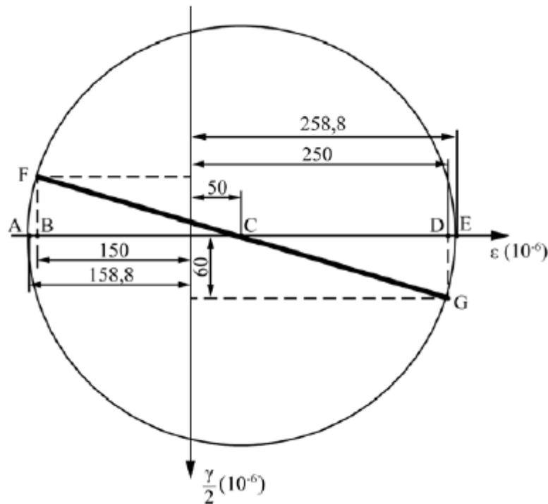
O estado plano de deformações pode ser representado graficamente para se determinar sua solução por meio das componentes das deformações por cisalhamento ( $\gamma$ ) e normal ( $\epsilon$ ). Na situação da figura precedente, que ilustra o círculo de Mohr para um estado plano de deformação, as deformações principais  $\epsilon_{\max}$  e  $\epsilon_{\min}$  são iguais, respectivamente, a
