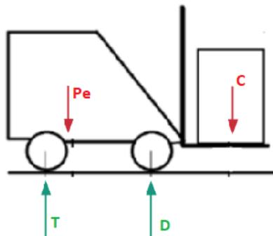
Onde  $P_e$  é o peso da empilhadeira,  $C$  o peso da carga,  $T$  é a reação no conjunto de rodas traseiro e  $D$  é a reação no conjunto de rodas dianteiro. Constituído o DCL, nota-se que temos duas incógnitas  $T$  e  $D$ , portanto precisamos de duas equações independentes para solucionarmos o problema, assim devemos aplicar as seguintes equações de equilíbrio:
