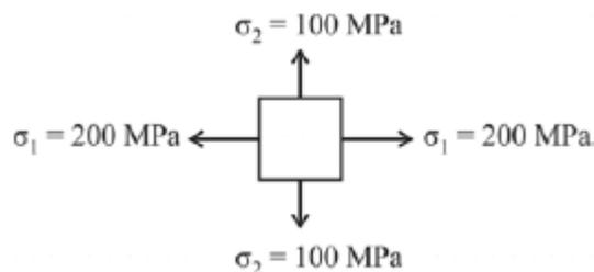
Um componente estrutural fabricado em aço dúctil está submetido a um estado plano de tensões, representado, em determinado ponto, pelo elemento de tensões mostrado na figura acima, em que  $\sigma_1 = 200 \text{ MPa}$  e  $\sigma_2 = 100 \text{ MPa}$ . Considerando a possibilidade de falha por escoamento, julgue o item abaixo, a respeito da resistência ao escoamento do material do referido componente.
