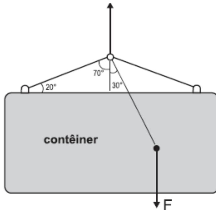
Se a força  $F$  resultante do peso do contêiner e da carga em seu interior é posicionada conforme indicado, o ângulo de inclinação em relação à horizontal, quando o sistema estiver em equilíbrio estático, será igual a
