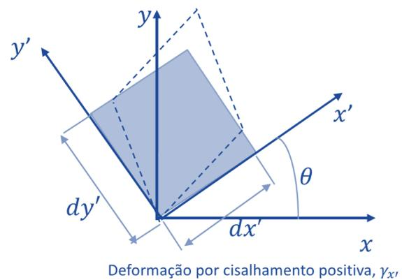
Visto isso, analogamente a tensão no plano, podemos afirmar que se um **estado de deformação em um ponto for conhecido**, de acordo com uma orientação determinada de um elemento do material, **podemos determinar** o estado de deformação **para uma orientação diferente** através das seguintes equações:
