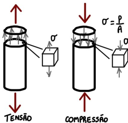
A tensão ocasionada por uma força axial pode ser de tração ou compressão conforme o seu sentido. Como foi nos informado no enunciado a tensão gerada pelo carregamento dado podemos encontrar a área da seção circular pela seguinte equação:
