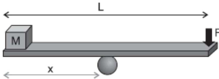
Uma prancha de madeira de massa desprezível e comprimento  $L = 2,8 \text{ m}$  é utilizada para manter em equilíbrio, na horizontal, um cubo pequeno de massa  $20,0 \text{ kg}$  ao realizar uma força  $F$  de  $80,0 \text{ N}$  em uma das extremidades da prancha.
