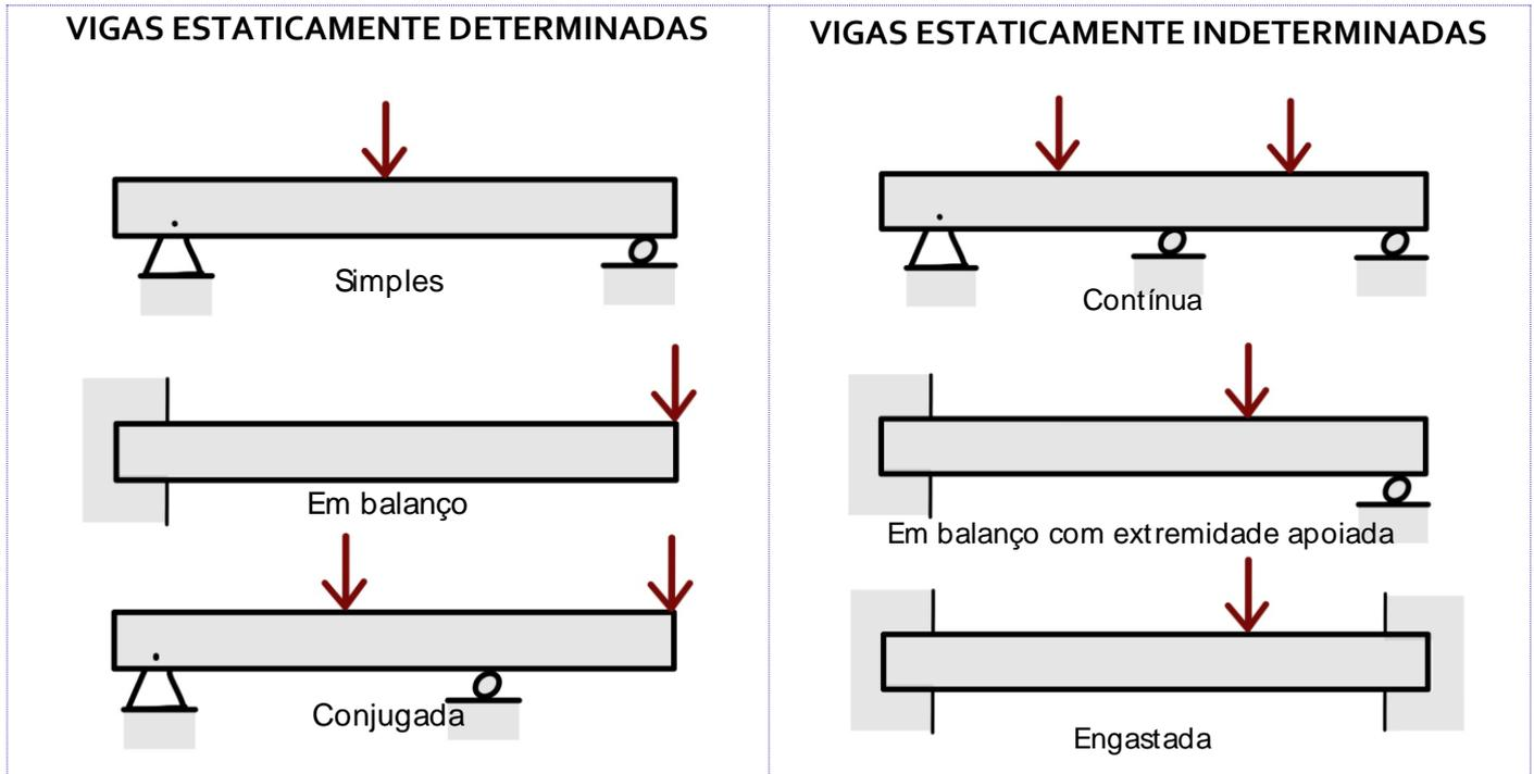
Podemos também identificar as vigas pelos **tipos de carregamentos externos** a qual estão expostas. Estas podem sofrer cargas concentradas, como vistas na figura acima ou distribuídas, conforme a figura abaixo.
