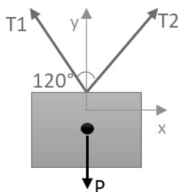
As **forças trativas**  $T_1$  e  $T_2$  são **opostas** logo suas componentes em X se anulam. As componentes do eixo Y das cordas é que sustentam a caixa e formam um ângulo de  $60^\circ$  com o eixo y imaginário que corta o centro da caixa. Por fim, aplicando as equações de equilíbrio, sabendo que as forças  $T_1$  e  $T_2$  são iguais e, que a força peso é igual a massa multiplicada pela aceleração da gravidade, obtemos:
