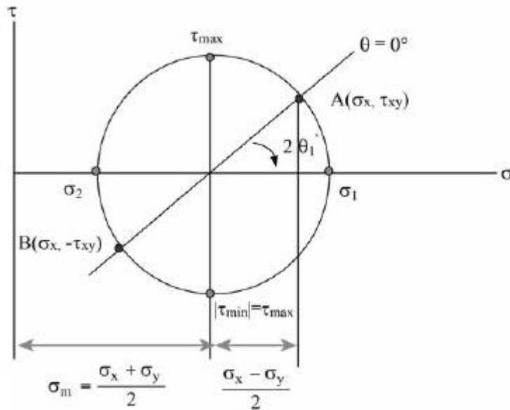
A figura precedente ilustra o círculo de tensões de Mohr, em que a ordenada de um ponto sobre o círculo representa a tensão de cisalhamento ( $\tau$ ) e a abscissa representa a tensão normal ( $\sigma$ ).
