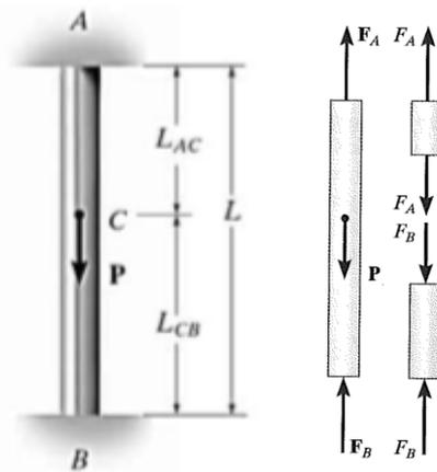
Vamos exemplificar o princípio da superposição com um exemplo em que um elemento estaticamente indeterminado carregado com uma carga axial. Neste caso a barra está presa em ambas as extremidades se tornando indeterminada, pois não é possível a determinação de suas reações através dos princípios de equilíbrio. Vejamos o DCL, ao lado, e a análise de equilíbrio:
