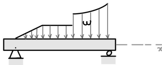
Por fim, a **força resultante da concentração** de uma força distribuída em uma viga sempre estará localizada no **centróide** da área em consideração. Portanto, podemos considerar uma carga distribuída concentrada em apenas uma resultante em um ponto e, assim, poderemos analisar os esforços em uma viga com carga distribuída através de análise estática direta.
