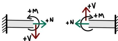
Na figura acima, temos uma viga com engaste a esquerda e outra com engaste a direita.
