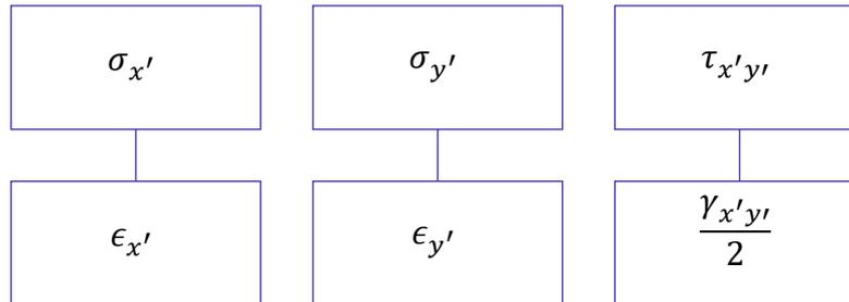
Devido à similaridade entre as tensões e deformações no plano podemos determinar a **direção do eixo e as deformações principais** ( $\epsilon_1$  e  $\epsilon_2$ ) pelas seguintes expressões:
