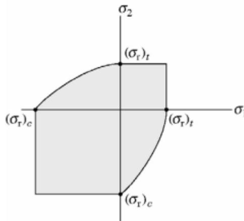
Cabe destacar, que devido a existirem imperfeições em materiais frágeis é difícil de prever a ruptura sob tensão deste tipo de material, por isso **teorias de falhas para materiais frágeis** devem ser utilizadas com **cautela**.
