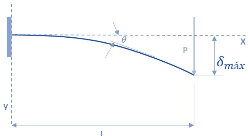
A obtenção das **equações para deflexão** em vigas é realizado através da **integração de equações diferenciais** que descrevem a curva da linha elástica da viga. Quando abordamos vigas com pequenos
