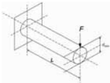
Considere que a barra de aço engastada de comprimento  $L$ , mostrada na figura acima, com módulo de elasticidade  $E$ , tenha sido submetida a uma carga  $F$ . Considerando a seção circular da barra, julgue o item a seguir.
