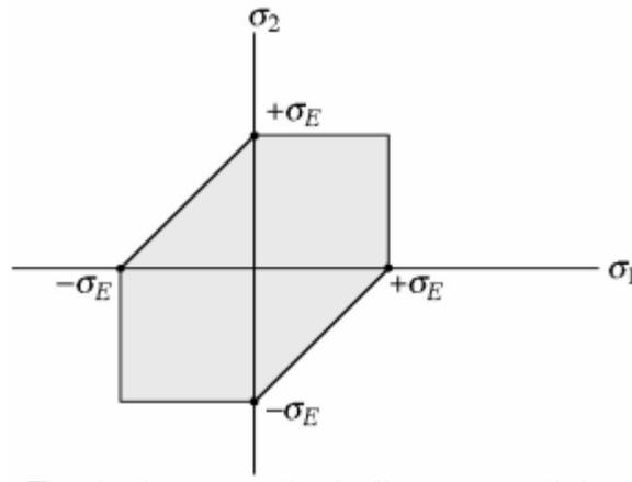
**Teoria da energia de distorção máxima ou critério de Von Mises/Hencky:** esta teoria afirma que o escoamento em **material dúctil** acontece quando a energia de distorção por unidade de volume do material for igual ou ultrapassar a energia de distorção por unidade de volume deste mesmo material quando sujeito a escoamento em um ensaio de tração. Este critério de falha é baseado nas distorções provocadas pela energia de deformação.
