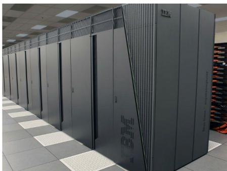
I. **Mainframe:** é um computador de grande porte, que possui alta capacidade de processamento e armazenamento de dados. O termo mainframe era utilizado para se referir ao gabinete principal que alojava a unidade central de processamento nos primeiros computadores. Anteriormente ocupavam um grande espaço e necessitavam de um
