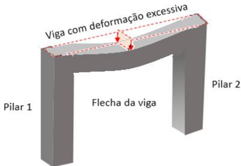
Figura 12: viga com deformação excessiva vertical ao centro mostrada pelas setas (essa deformação vertical no centro da viga é chamada de flecha da viga)
