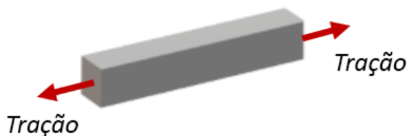
Figura 35: tração simples em uma viga
