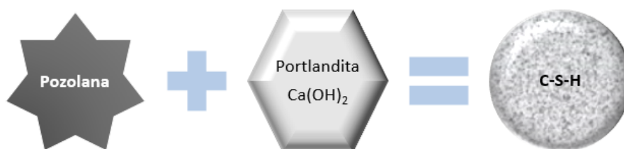
Figura 8: formação de C-S-H pela pozolana
