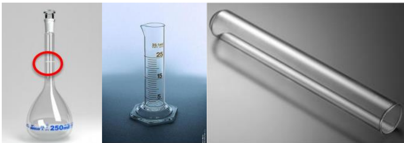
Legenda: À esquerda: vidraria volumétrica. Ao centro: vidraria graduada. À direita: vidraria sem marcação. Fonte: UNESP.
