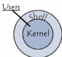
**Shell** - É a interface que funciona como intermediário entre o usuário e o sistema operacional. A sua função é ler a linha de comando digitada pelo usuário, interpretar seu significado, executar o comando e devolver o resultado pelas saídas. Na verdade, a interface Shell é um arquivo executável, encarregado de interpretar comandos, transmiti-los ao sistema e devolver resultados. Por este motivo foi escolhido o nome Shell, que é um
