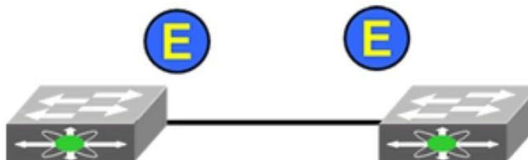
Um **ISL Trunk** é um ISL lógico que provê uma largura de banda maior, agrupando conexões físicas (de mesma capacidade ou de capacidades diferentes):
