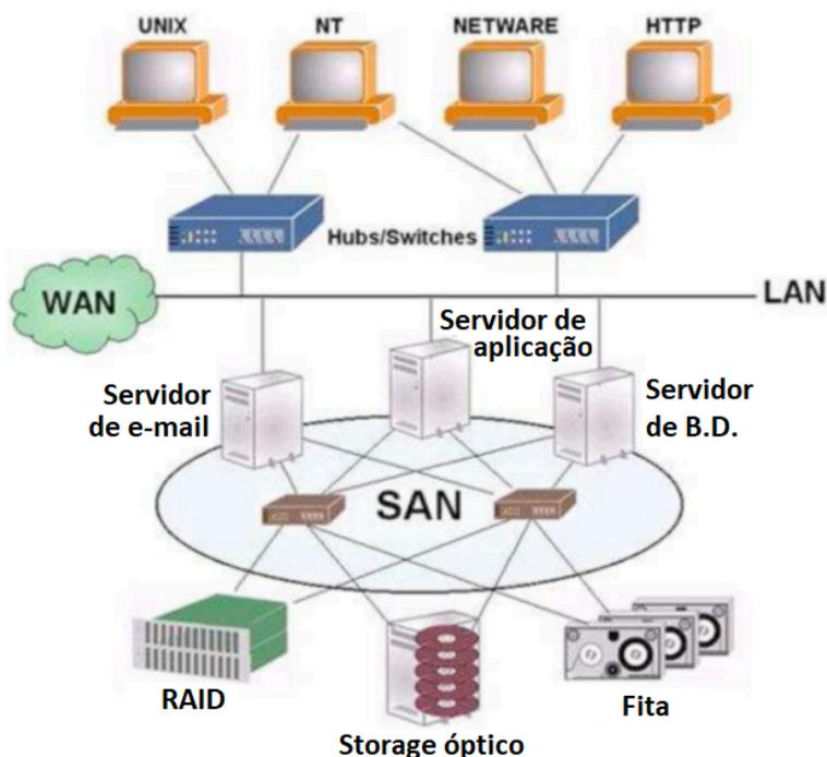
Na SAN podemos ver diversos tipos de armazenamento de dados: RAID, *storage* óptico, armazenamento em fitas, entre outros. Um termo importante que às vezes é cobrado em prova de concurso é [LAN-free backup](#), que é um backup de um servidor de dados para um *storage* central sem enviar os dados através da LAN.
