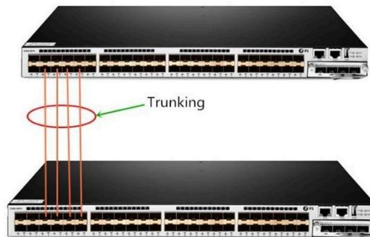
Troncos (*trunks*) são utilizados para transportar o tráfego que pertence a várias VLANs (Virtual LANs) entre dispositivos no mesmo link. Um dispositivo pode determinar qual VLAN o tráfego pertence por seu identificador de VLAN. O identificador VLAN é uma etiqueta (*tag*) que é encapsulado com os dados. ISL e 802.1Q dois tipos de encapsulamento que são usados para transportar dados de várias VLANs através de ligações interurbanas.
