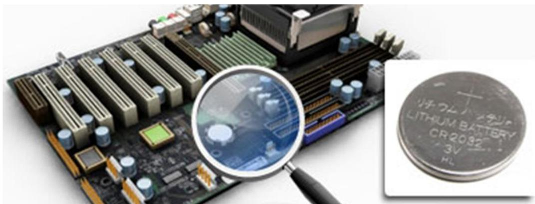
Essa bateria alimenta a memória CMOS (que guarda os dados de configuração usados no SETUP). Então, caso seja realizada a gravação de uma informação equivocada através do SETUP, causando algum erro de configuração do computador, é possível resolver o problema retirando a bateria da placa-mãe. Dessa forma será permitido que todos os dados sejam novamente inseridos após a reenergização do circuito.
