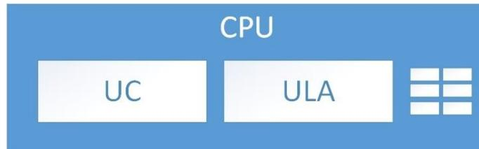
III. Os barramentos do processador são paralelos (diferente de USB, por exemplo, que é serial). Através deles há a transmissão de dados, endereços e sinais de controle entre o processador (CPU), a memória e os dispositivos de entrada/saída.
