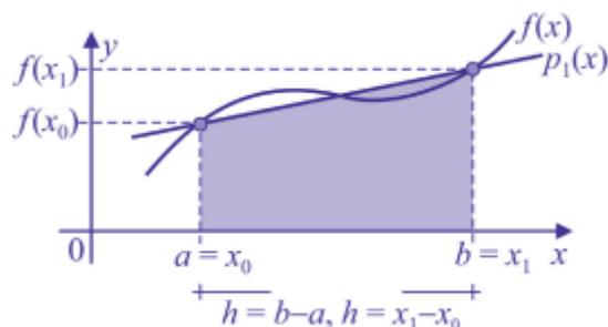
A figura precedente ilustra a regra do trapézio, um método de integração numérica que aproxima a área sob o gráfico da função  $f(x)$  pela área de um trapézio, em um intervalo  $[a, b]$  contido no domínio da função. Nessa aproximação, o erro  $E_T$  é estimado na forma  $|E_T| \leq [h^3 / 12] \max_{x \in [a, b]} |f''(x)|$ , em que  $h = b - a$  é o comprimento do intervalo  $[a, b]$  e  $f''(x)$  é a derivada segunda de  $f(x)$ .
