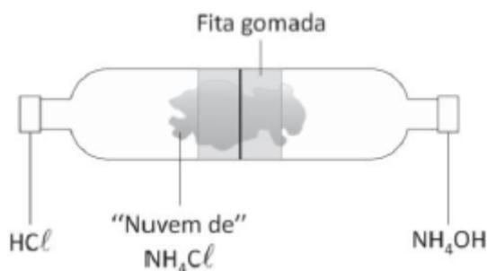
Em uma das tampas foi colocado um algodão embebido em ácido clorídrico ( $\text{HCl}$ ) e, na outra, um algodão embebido em hidróxido de amônio ( $\text{NH}_4\text{OH}$ ). As tampas foram atarraxadas e, em alguns segundos, os alunos foram surpreendidos com a formação de uma “nuvem” esbranquiçada, próxima ao centro da montagem. O professor explicou que a nuvem correspondia a uma espécie de poeira de cloreto de amônio ( $\text{NH}_4\text{Cl}$ ).
