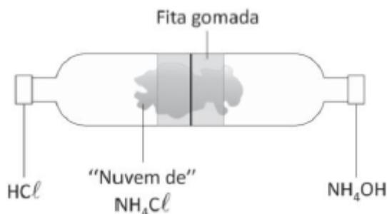
Em uma das tampas foi colocado um algodão embebido em ácido clorídrico (HCl) e, na outra, um algodão embebido em hidróxido de amônio (NH<sub>4</sub>OH). As tampas foram atarraxadas e, em alguns segundos, os alunos foram surpreendidos com a formação de uma "nuvem" esbranquiçada, próximo ao centro da montagem. O professor explicou que a nuvem correspondia a uma espécie de poeira de cloreto de amônio (NH<sub>4</sub>Cl).
