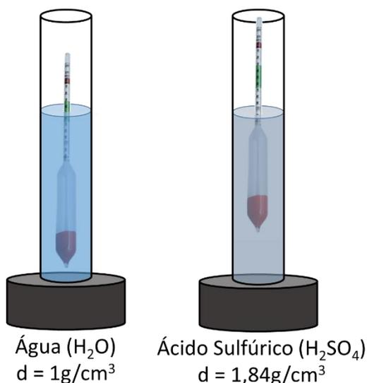
Outra aplicação bastante popular dos densímetros é medir quanto de água está misturada ao álcool. Como o álcool é menos denso que a água, quanto maior a densidade do líquido (água+álcool), menor será a concentração de álcool na solução.
