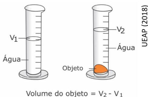
A massa (m) da pedra pode ser pesada em uma balança analítica e a densidade obtida pela relação m/V.
