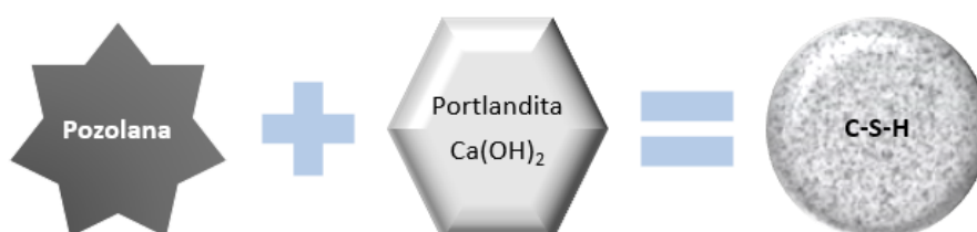
Figura 8: formação de C-S-H pela pozolana
