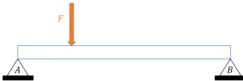
Viga biapoiada com carga concentrada
