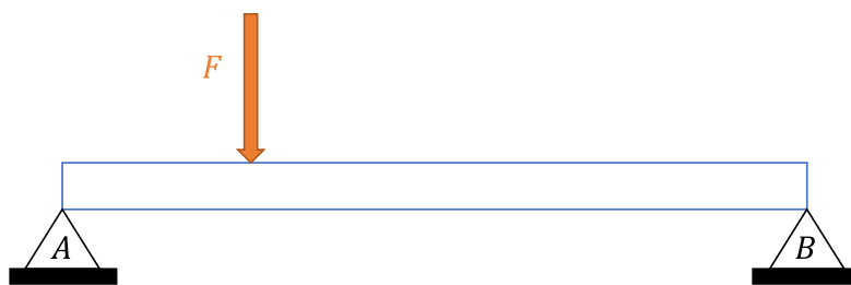
Viga biapoiada com carga concentrada
