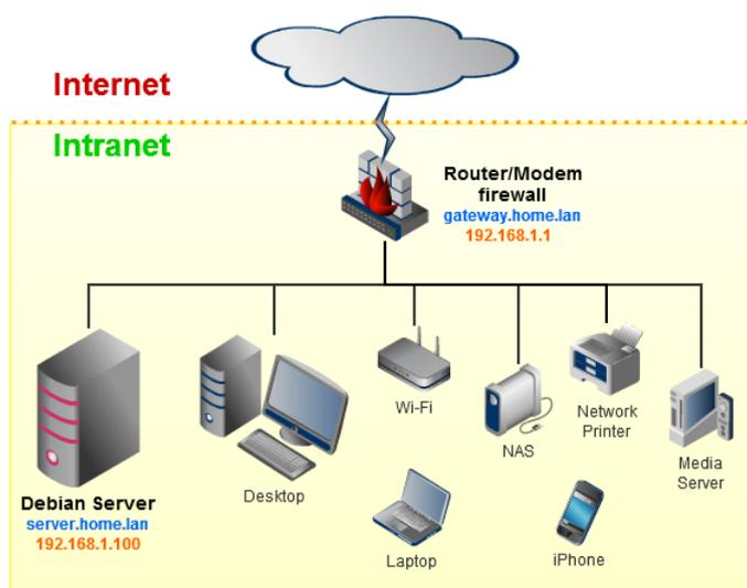
Na figura acima podemos visualizar um exemplo de Intranet. A linha preta é a conexão da rede com a Internet, porém todos os dispositivos que estão apresentados após o equipamento denominado modem, fazem parte da Intranet.
