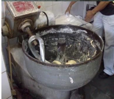
**Situação de grave e iminente risco 6:** Batedeira de indústria de panificação sem dispositivo de proteção móvel intertravada, que impeça o acesso à zona de perigo (bacia), quando em operação, e sem botões de emergência (dentre outros itens). A máquina deve ser **interditada**.
