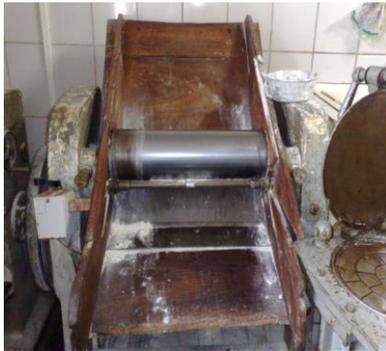
**Situação de grave e iminente risco 7:** Cilindro de massa usado na indústria de panificação (muito antigo..) sem dispositivo de proteção móvel intertravada e sem botões de parada de emergência (dentre outros itens). **A máquina deve ser interdita.**
