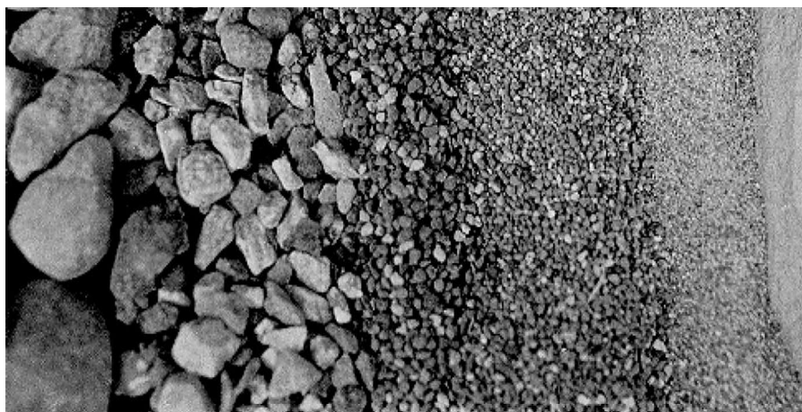
Figura 05: Grãos de amostra de solo segregado por dimensão
