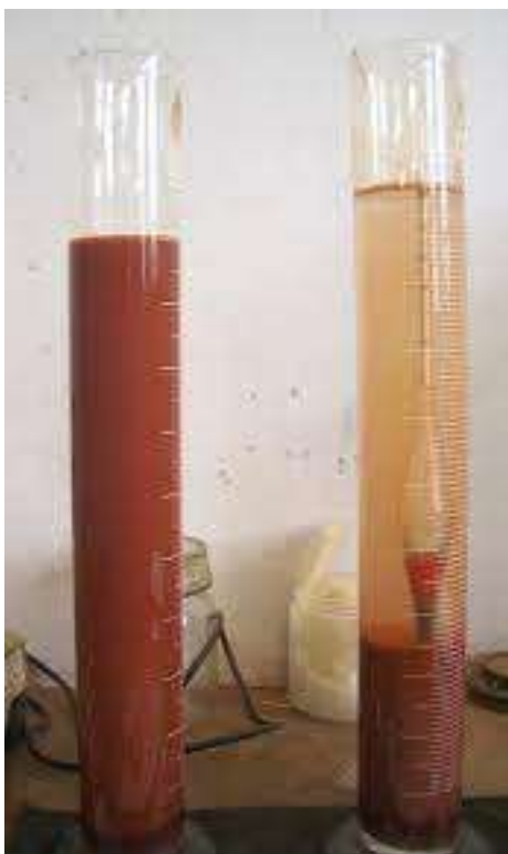
Figura 07 - Proveta com solução contendo fração fina do solo
