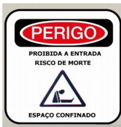
Figura 1.2: Sinalização obrigatória para espaço confinado.
