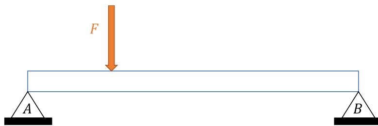
Viga biapoiada com carga concentrada
