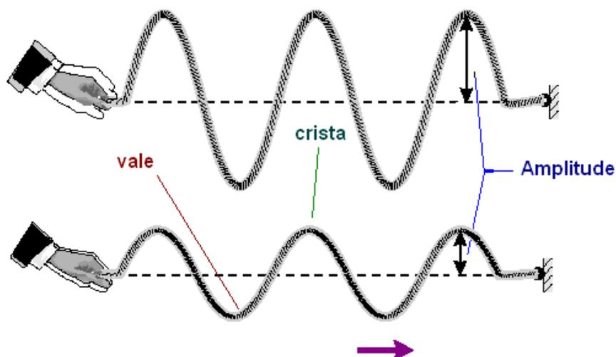
A amplitude está indicada na figura e ela não influencia na velocidade da onda, na verdade a amplitude está ligada diretamente à energia conduzida pela onda, conforme visto na parte teórica. Ondas de **grande amplitude** carregam **mais energia** para o meio, enquanto que ondas de **pequenas amplitudes** carregam **pouca energia**.
