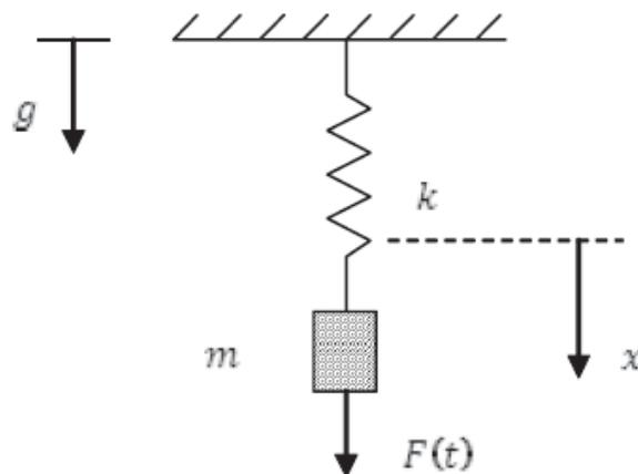
A figura acima ilustra um sistema massa-mola em que  $g$  é a aceleração da gravidade, a mola é linear, de constante elástica  $k$  tal que a força elástica exercida sobre a massa  $m$  é proporcional ao deslocamento na direção  $x$ . É imposta ao sistema uma força externa expressa pela relação  $F(t) = F_0 \cdot \text{sen}(\omega t)$ . A linha tracejada marca a posição de repouso do sistema, na ausência da força. Com base nas informações apresentadas na figura, julgue o item a seguir.
