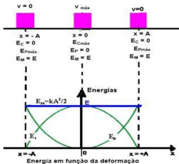
Do gráfico acima podemos perceber que quando a deformação vale A, a energia cinética é mínima (zero, ponto de inversão de movimento) e a energia potencial é máxima. Desta forma, toda a energia mecânica está concentrada na forma de energia potencial elástica.
