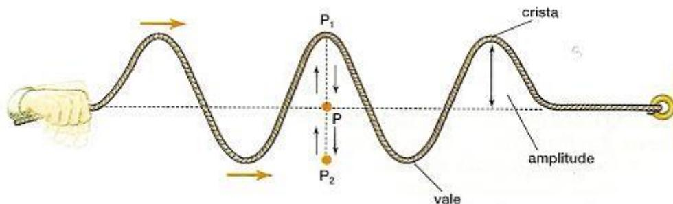
Na figura acima você percebe uma onda em uma corda que se propaga da esquerda para a direita.
