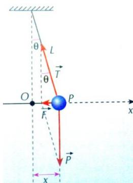
A figura acima mostra as forças que atuam no pêndulo durante seu movimento. Note que a força “F” é responsável por trazer o corpo de volta para a posição de equilíbrio “O”. Logo, se mostrarmos que a força “F” é do tipo  $F = - K.x$ , então estaremos diante de um exemplo de MHS.
