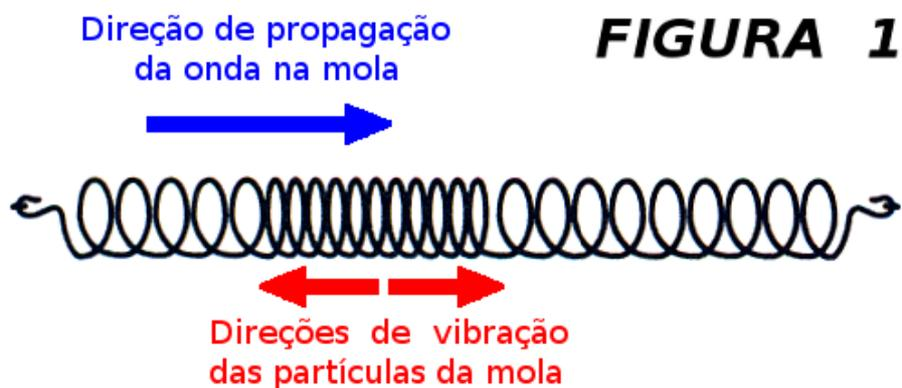
Veja que a vibração tem a mesma direção de propagação. O som é um bom exemplo de onda no dia a dia que é longitudinal.
