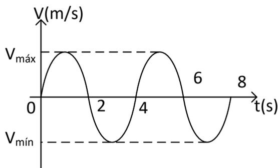
Vamos encarar o gráfico acima como um exemplo, no qual devemos determinar a pulsação, o período, e a equação da velocidade, bem como a velocidade máxima. Admita que a amplitude de oscilação seja de 10cm, para efeito de cálculo, e que no instante de tempo  $t = 0$  o corpo passa pela posição  $+A$  (amplitude positiva).
