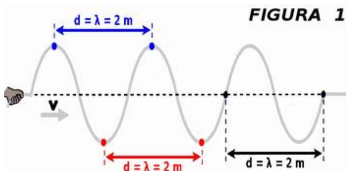
A distância correspondente ao comprimento de onda pode ser dada de três formas:
