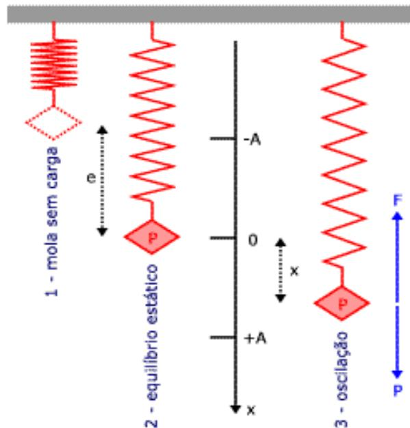
A força restauradora será dada pela diferença entre a força elástica e o peso do corpo.
