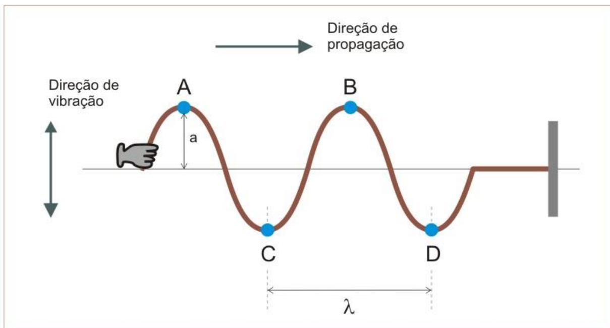
Na figura acima, note que a onda percorre uma distância igual a um comprimento de onda enquanto decorre o tempo correspondente a um período de oscilação.
