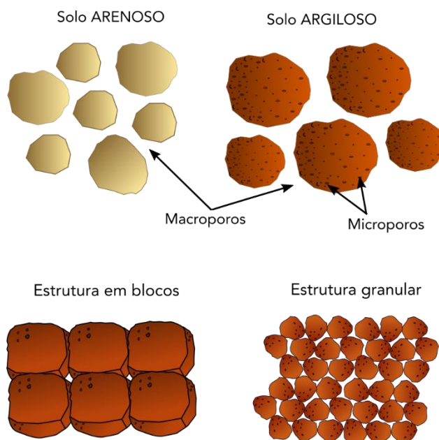
Representação esquemática da ocorrência de macroporos e microporos em função da textura do solo (acima) e da estrutura (abaixo).
