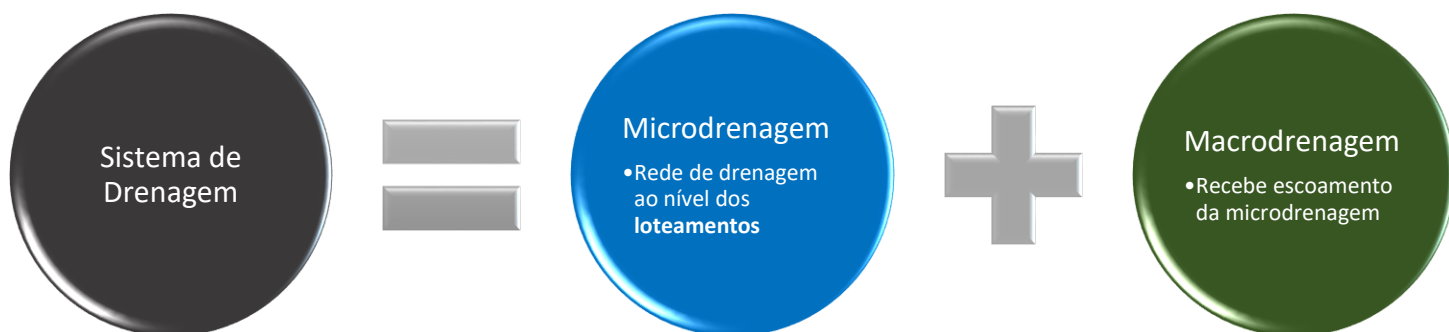
Figura 51: partes de um sistema de drenagem
