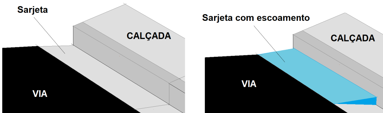
Figura 54: Sarjeta com escoamento
